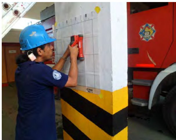
Verificación del refuerzo longitudinal y transversal (estribos) en el tramo central de la columna del módulo de doble altura. Se indica la separación aproximada.
